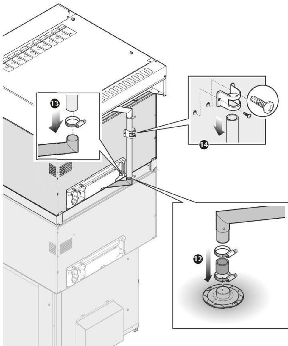
Para conectar un segundo horno se debe utilizar la extensión incluida en el kit de superposición
