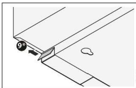
**9\*** Si el horno situado bajo la campana tiene apertura lateral\*, se debe quitar la placa derecha o izquierda de la campana (dependiendo del sentido en el que se abra la puerta del horno) para crear el espacio necesario para la bisagra superior del horno.
